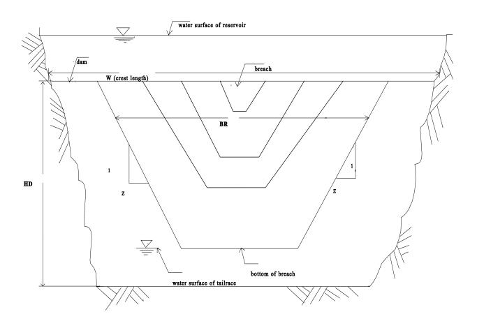
FIGURE 1. DEFINITION SKETCH OF BREACH PARAMETERS
