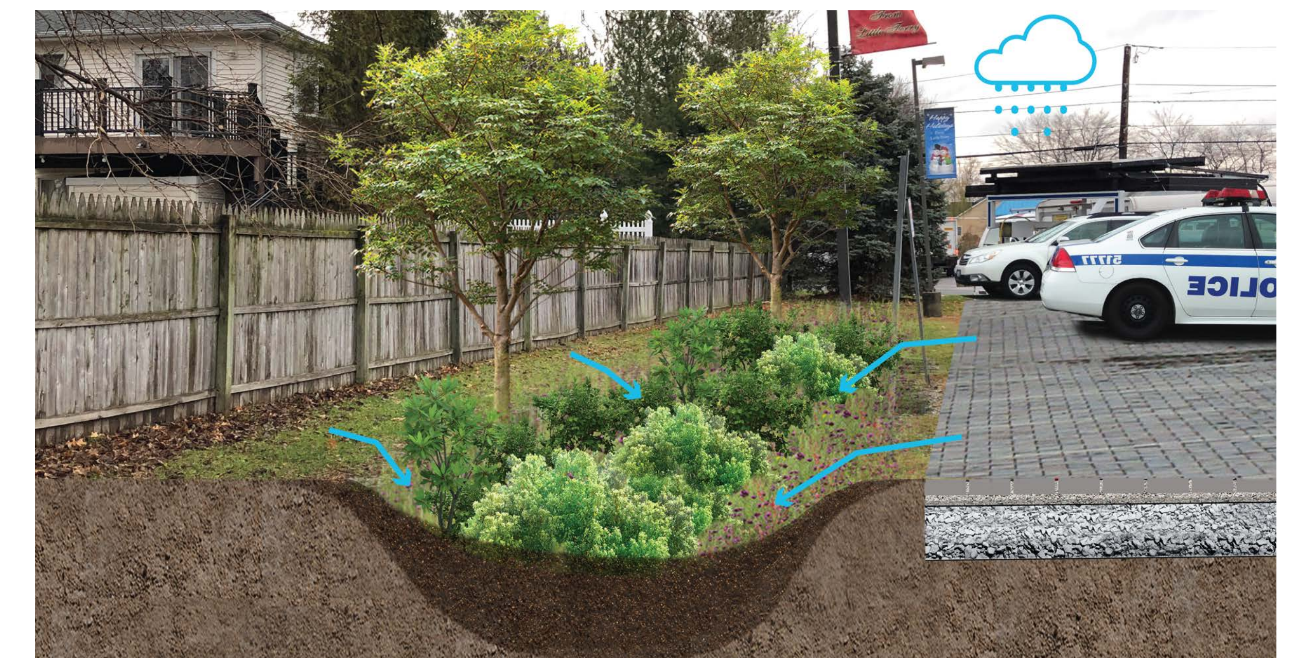
경사 설치 및 고유 식재조립
